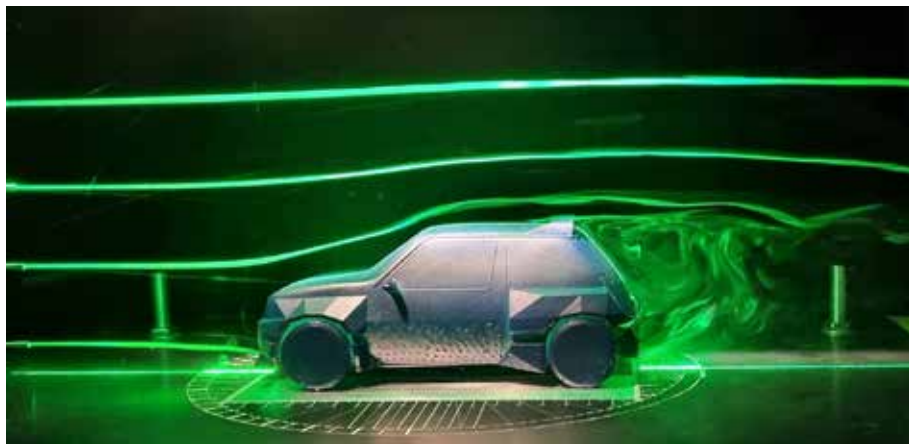
Áttervezett Renault R5 autó 1:20 méretarányú szélcsatorna modellje körüli áramlás láthatóvá tétele: Mihály Gergely ipari termék- és formatervező mérnök alapszakos hallgató szakdolgozat-készítése keretében az általa áttervezett autómódel aerodinamikai paramétereit mérte szélcsatornában (Fotó: Mihály Gergely)
